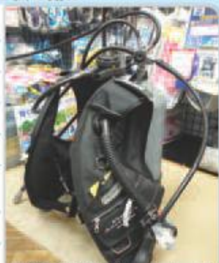
空気タンクにBCD、レギュレーター、残圧計などを取り付けた状態
